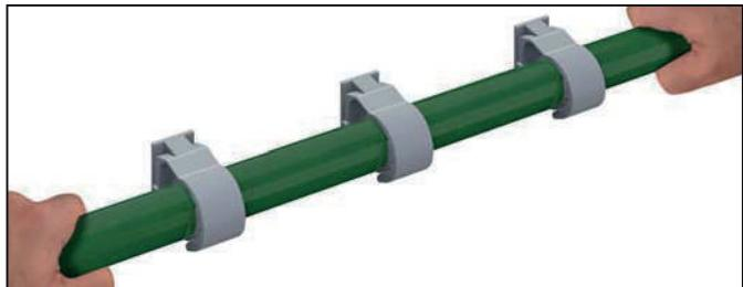
Une deuxième pression du tube sur la base du collier permet le verrouillage de ce dernier (3 colliers peuvent ainsi être verrouillés simultanément en seulement 19").
